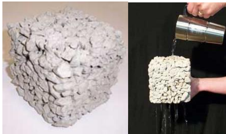
Figura 6. Hormigón sin agregados finos
