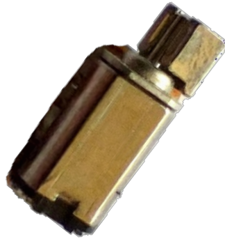
Figura 17. Alarma vibrante en el brazalete.
