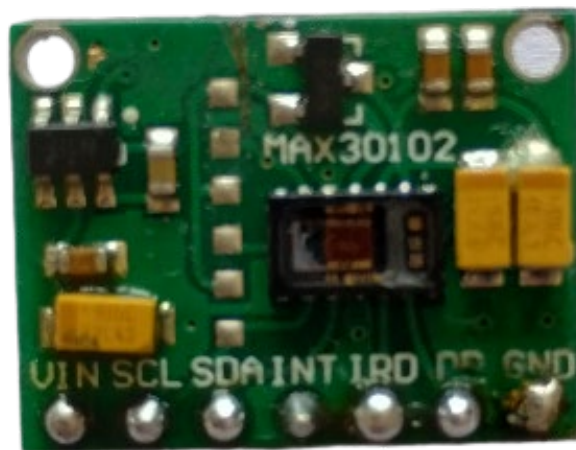
Figura 11. Sensor MAX30100 utilizado en el brazalete.
