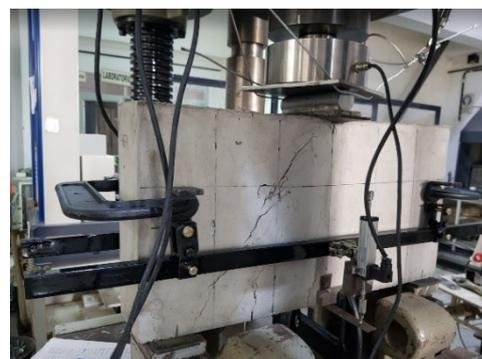
**Figura 1** – Instrumentación del ensayo a flexión de las VGA.
