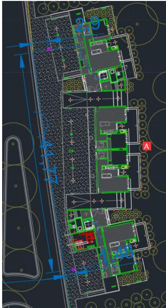
Figura 53 - Acometida Segunda Cámara Edificio A - 1
