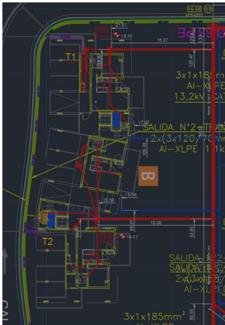
Figura 34 - Plano Servicios Subterráneos Bloque B
