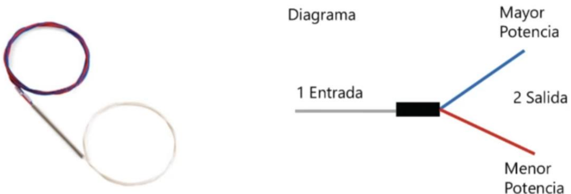
Figura 23 - Diagrama Splitter Asimétrico. Extraído de: [5]
