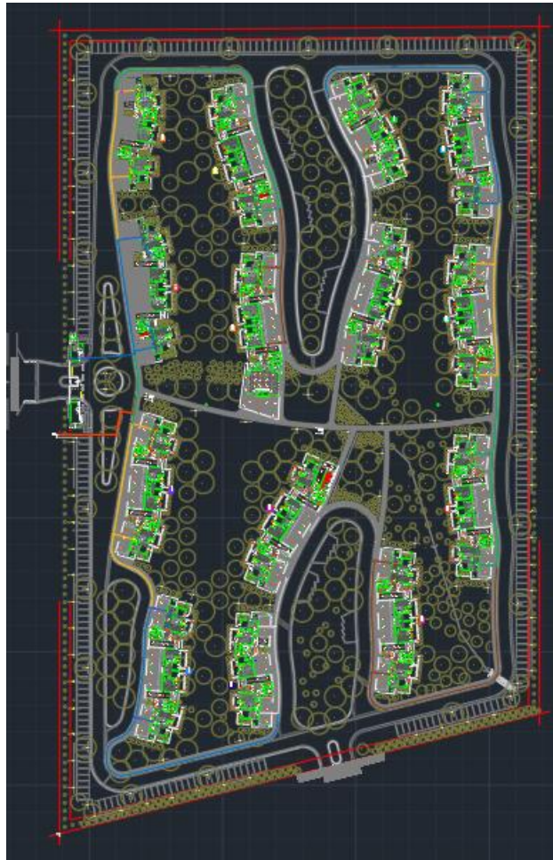
Figura 42 - Plano Despliegue de Fibra Óptica sobre Complejo Residencial
