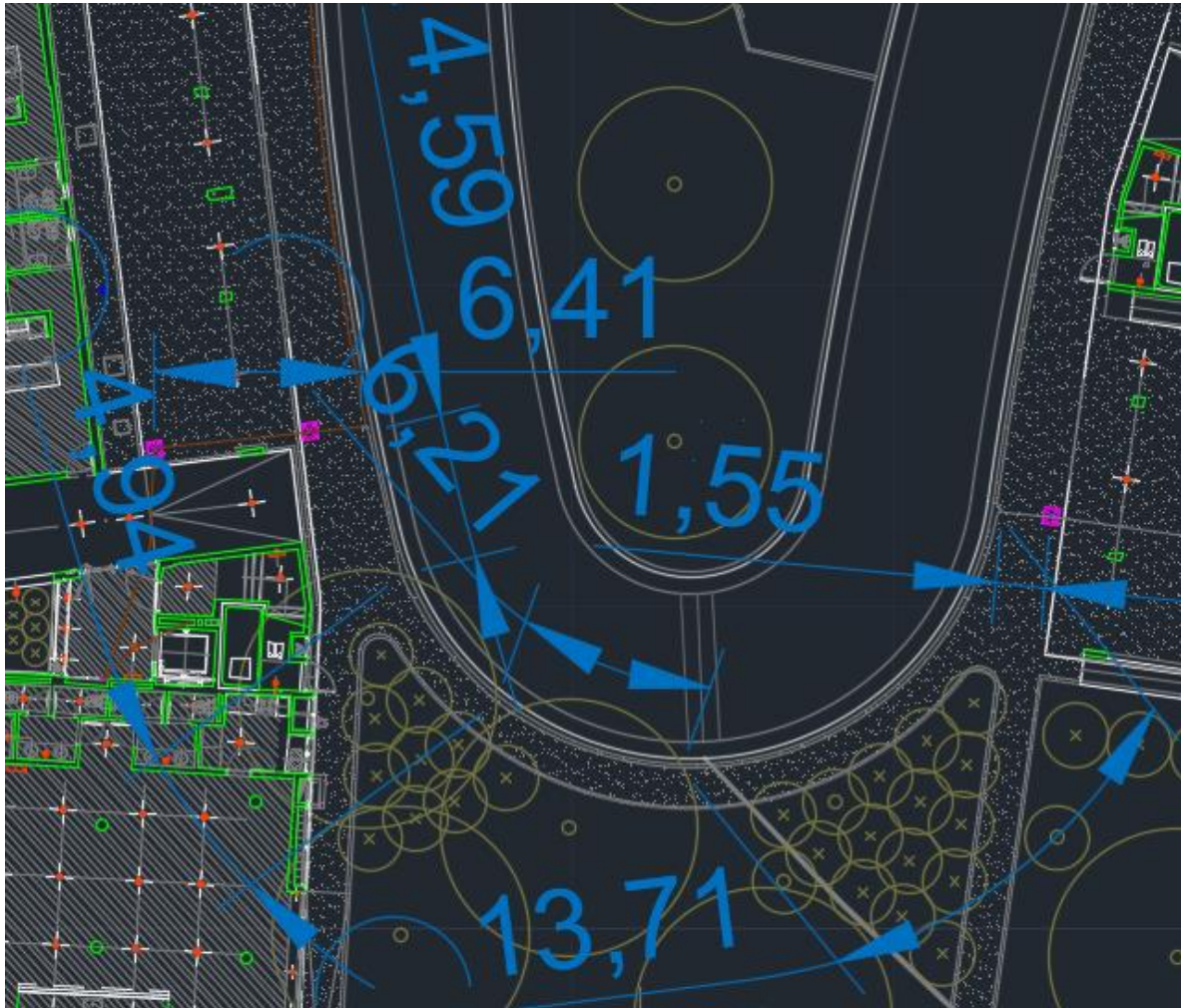
Figura 90 - Acometida Primera Cámara Edificio E
