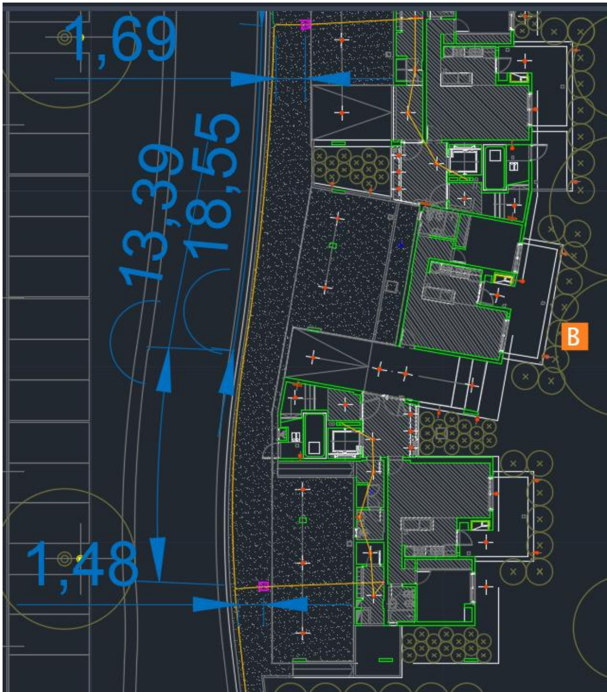
Figura 72 - Acometida Segunda Cámara Edificio B
