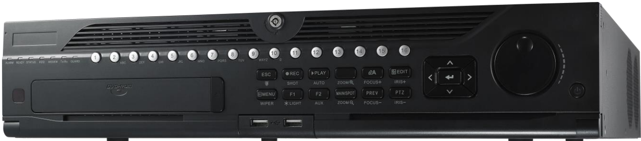
Figura 139 - Frente NVR 64 Cámaras. Extraído de: [27]
