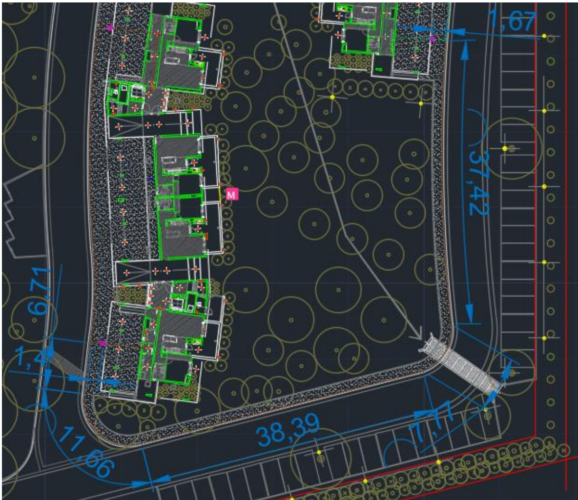
Figura 110 - Acometida Primera Cámara Edificio M
