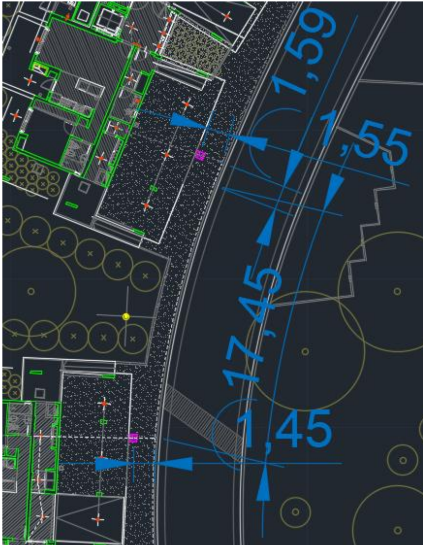
Figura 118 - Acometida Primera Cámara Edificio K
