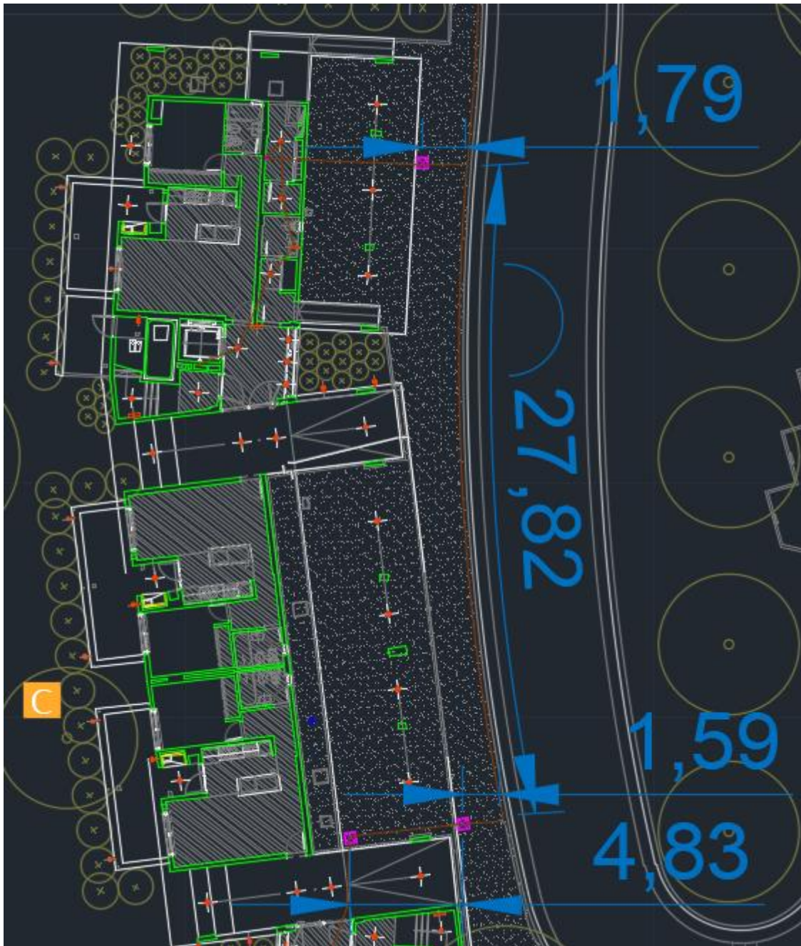
Figura 86 - Acometida Segunda Cámara Edificio C
