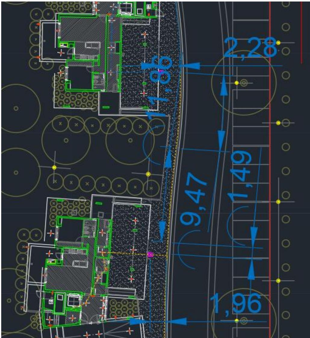
Figura 102 - Acometida Primera Cámara Edificio G
